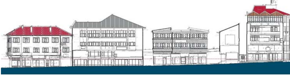
Şekil 3. İnönü Caddesi üzerinde yer alan konutların topoğrafyaya yerleşimi (Mostar Mimarlık ve Restorasyon)
