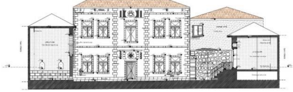
Şekil 8. Konağın Batı Cephesi, sağ yan ana giriş solda eyvan (Çalın vd., 2015).
