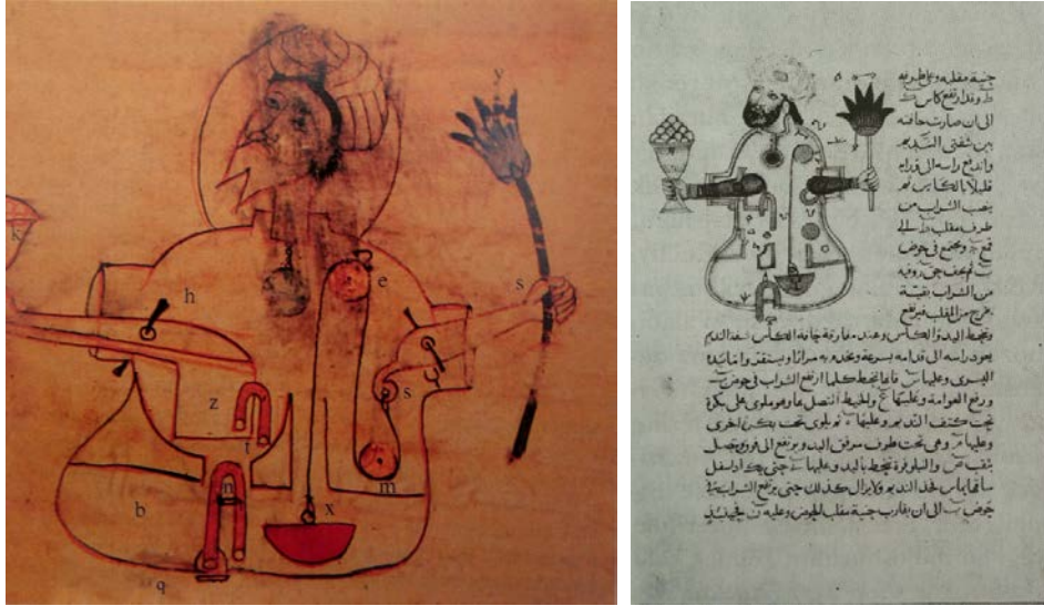
Resim-2. Maskara otomatının iç aksamını gösteren çizim (Cezerî, 2002, s. 139, 142)
